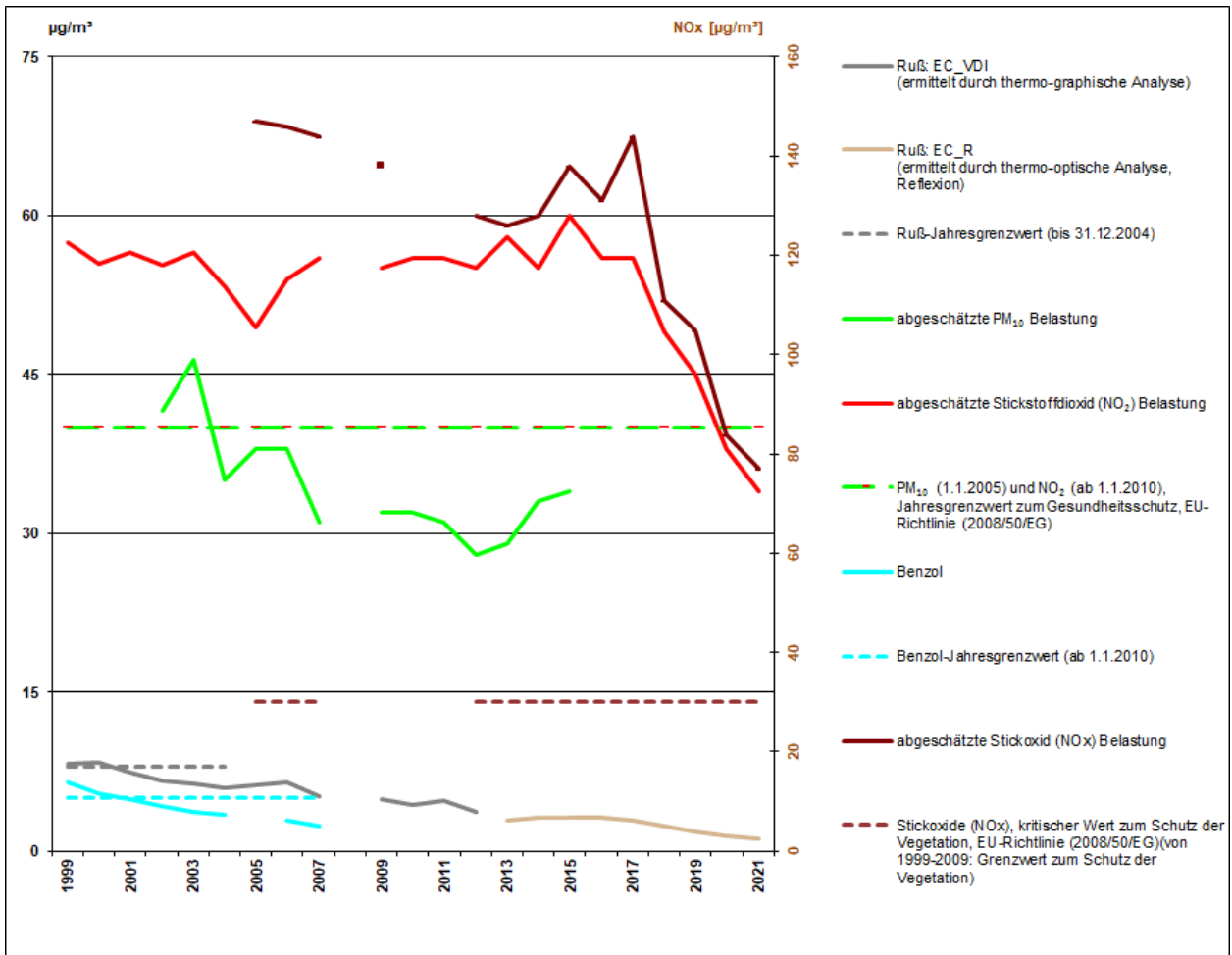
Abbildung 1: Verlauf der absoluten Jahresmittelwerte in µg/m 3 für NO 2 , NO x , Ruß, PM 10 und Benzol am MP533
